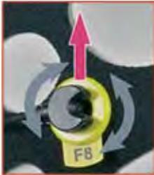
Lösen Sie die Elektrode mit hin- und herdrehenden Bewegungen am Elektrodenkörper aus der Halterung.
