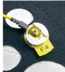
Lösen Sie die Elektrode aus der Halterung, indem Sie sie vorsichtig aus der Halterung ziehen. Fassen Sie dabei am Kabelsteg an und ziehen sie nicht am Kabel.
