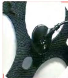
Nehmen Sie die Elektrode an der verstärkten Stelle des Kabels kurz vor dem Elektrodenkörper und entfernen diese nach leichtem Weiten des Haubenstoffs.
