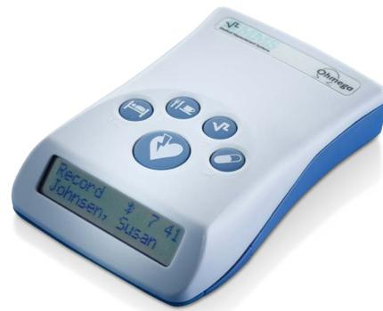
Das *Ohmega* ist ein sehr einfach anzuwendender Recorder zur Diagnose von gastroösophagealen Refluxkrankheiten (GERD). Es ist ein kleines und leichtes ambulant System, welches die Impedanzaufnahme und die pH-Messung kombiniert.
