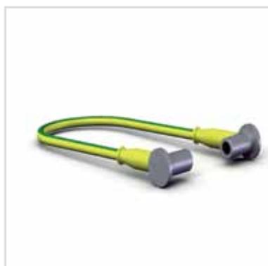
**Merkmale:** Hochflexibler Leiter 6 mm<sup>2</sup> mit grün-gelber PVC-Isolation; beidseitig mit der Winkelbuchse POAG KBT6 DIN ausgestattet.
